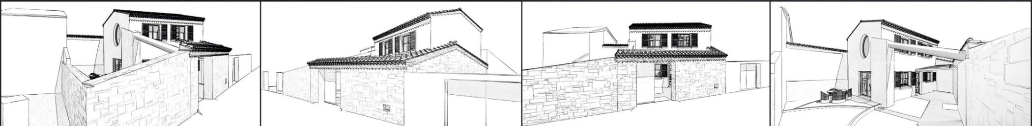
Construction d'une maison en R+1, sur la base d'une grange avec maintien des murs de pierres périphériques
